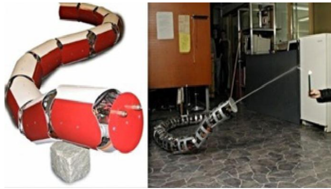
(d) Robot Snakes Used in Nuclear Sites.
