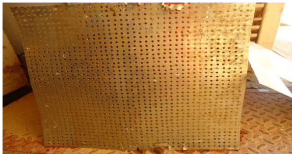
شكل 1: الألواح المثقبة المستخدمة في حوض الترسيب
