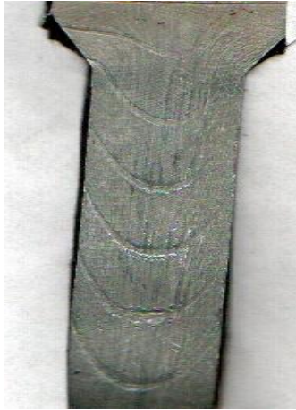
شكل (21- أ) عينة نصفية عند سرعة مدك 10 مم/د
