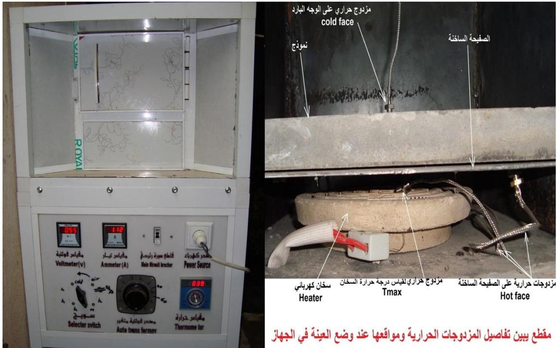
شكل (5) جهاز فحص الموصلية الحرارية
