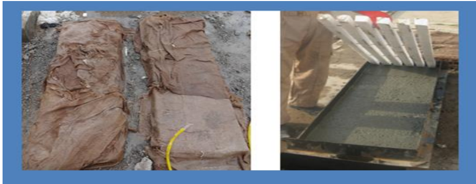
الشكل. 6 طريقة صب ومعالجة النماذج
