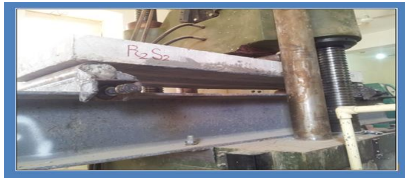
شكل 10 طريقة فحص نماذج السقوف الخرسانية المجوفة بعد التقوية بالياف الكربون
