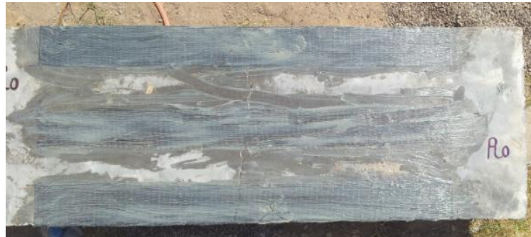
شكل 9 تقوية النماذج باستخدام الياف الكربون
