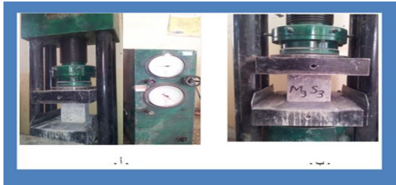
شكل. 7 طريقة فحص المكعبات الخرسانية للخلطات المختلفة
